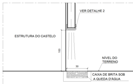
DETALHE 1 SAÍDA DOS TUBOS EXTRAVASORES SEM ESCALA
