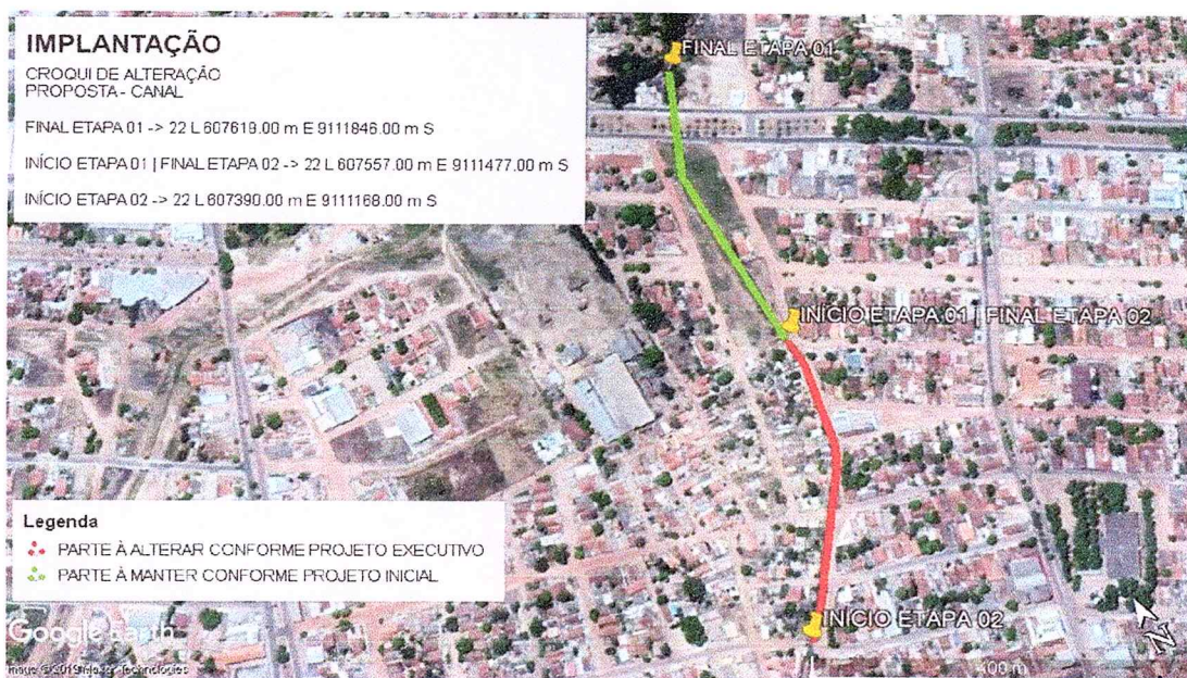
Figura 14 - Alteração proposta para o trecho 1º Trecho em Terra Armada e 2º Trecho da obra em Concreto
